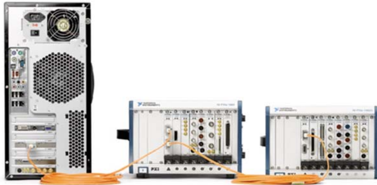
Σχήμα 2.32: Διασύνδεση δύο μονάδων PXI σε υπολογιστή μέσω πρωτοκόλλου MXI-Express.
