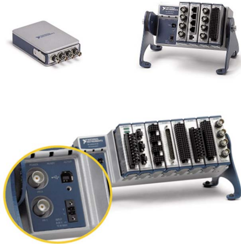
Σχήμα 2.34: Πλαίσιο μονάδα NI compact DAQ α) 1, β) 4 και γ) 8 θέσεων.
